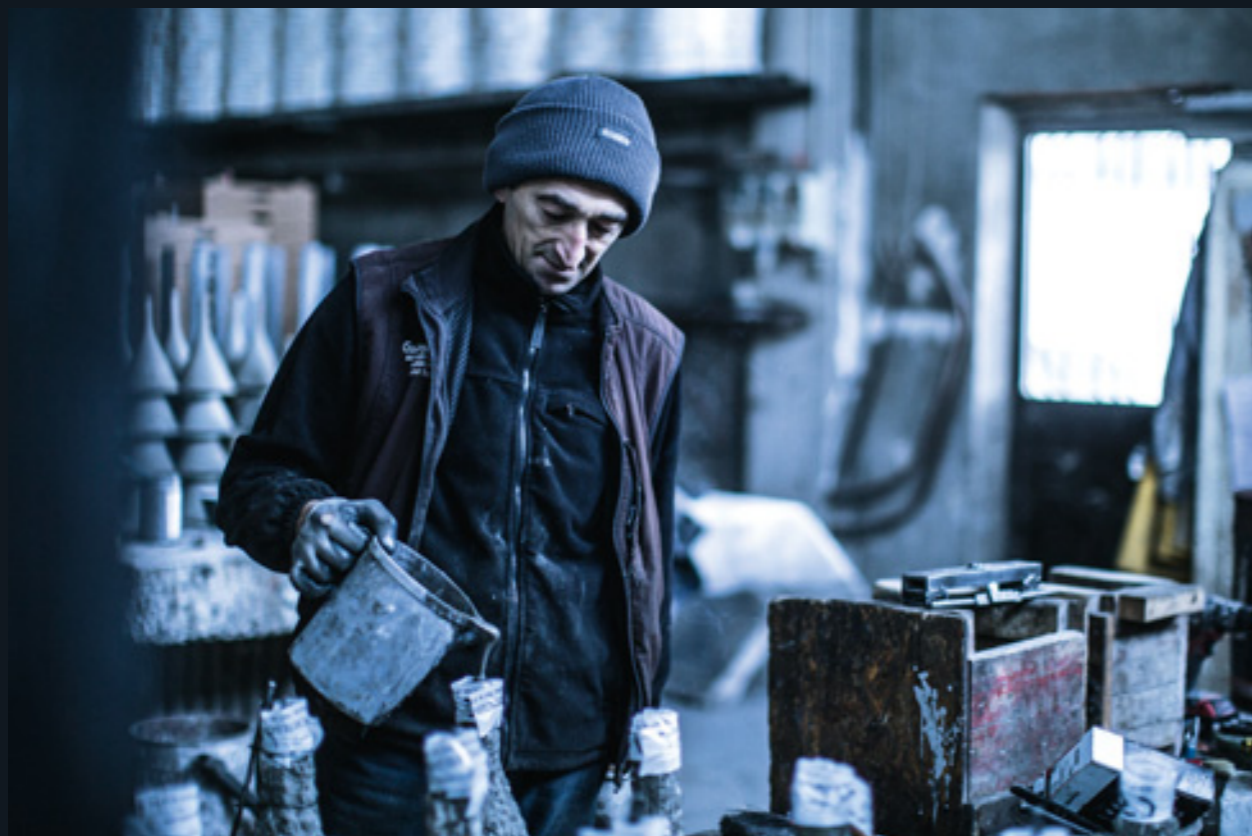
La miscela di cemento viene versata per caduta a gravità nello stampo — The cement mixture is poured by the force of gravity into the mould — 靠重力將水泥混合物倒入人工吹制模 — La mezcla de cemento se vierte mediante caída por gravedad en el molde — Le mélange de ciment est coulé par gravité dans le moule — ページ - 混合されたセメントは手で作られた鑄型の上に自然に注がれる — Die Zementmischung fließt dank der Schwerkraft in die Form — Crea, 2017
