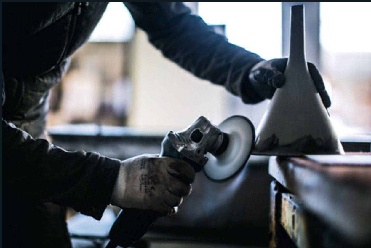
Rifinitura a mano dei bordi della lampada — Hand-finishing of the lamp edges — 手工加工灯沿 — Acabado a mano de los bordes de la lámpara — Finition à la main des bords de la lampe — ページ - 照明器具のエッジの手作業による仕上げ — Manuelle Feinbearbeitung der Ränder — Crea , 2017
