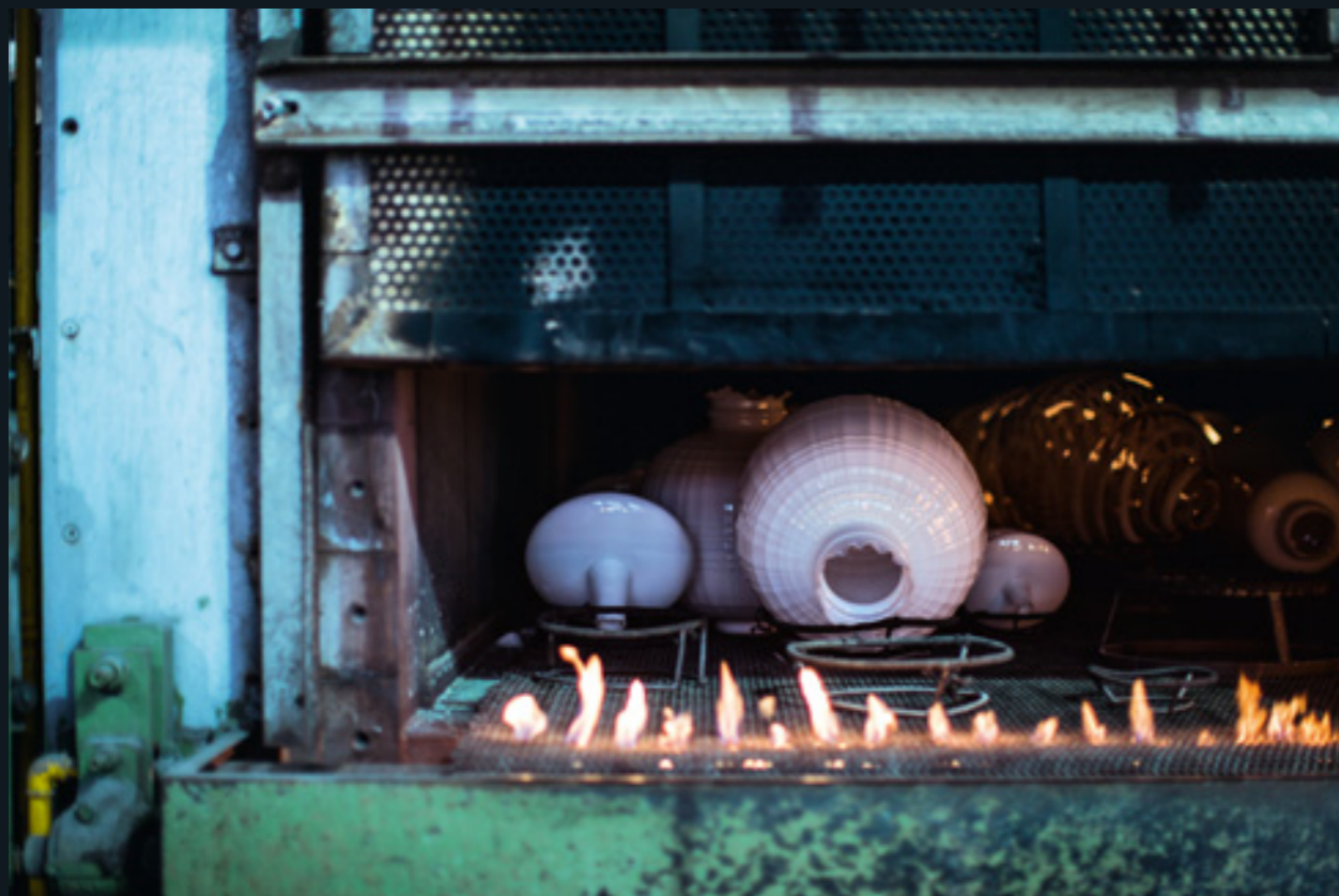
Forno per la ricottura del vetro dopo la soffiatura a bocca nello stampo — Furnace for curing glass after it has been hand-blown in the mould — 完成模具内的人工吹制后用于固化玻璃的火炉 — Horno para la cocción del vidrio tras el soplado a boca en el molde — Four pour la deuxième cuisson du verre après soufflage à la bouche dans le moule — ページ型吹き技法を用い製作された吹きガラスを二度焼きする窯 — Kühlöfen, in dem das Glas nach dem Einblasen in die Form abgekühlt wird — Vetrofond, 2017
