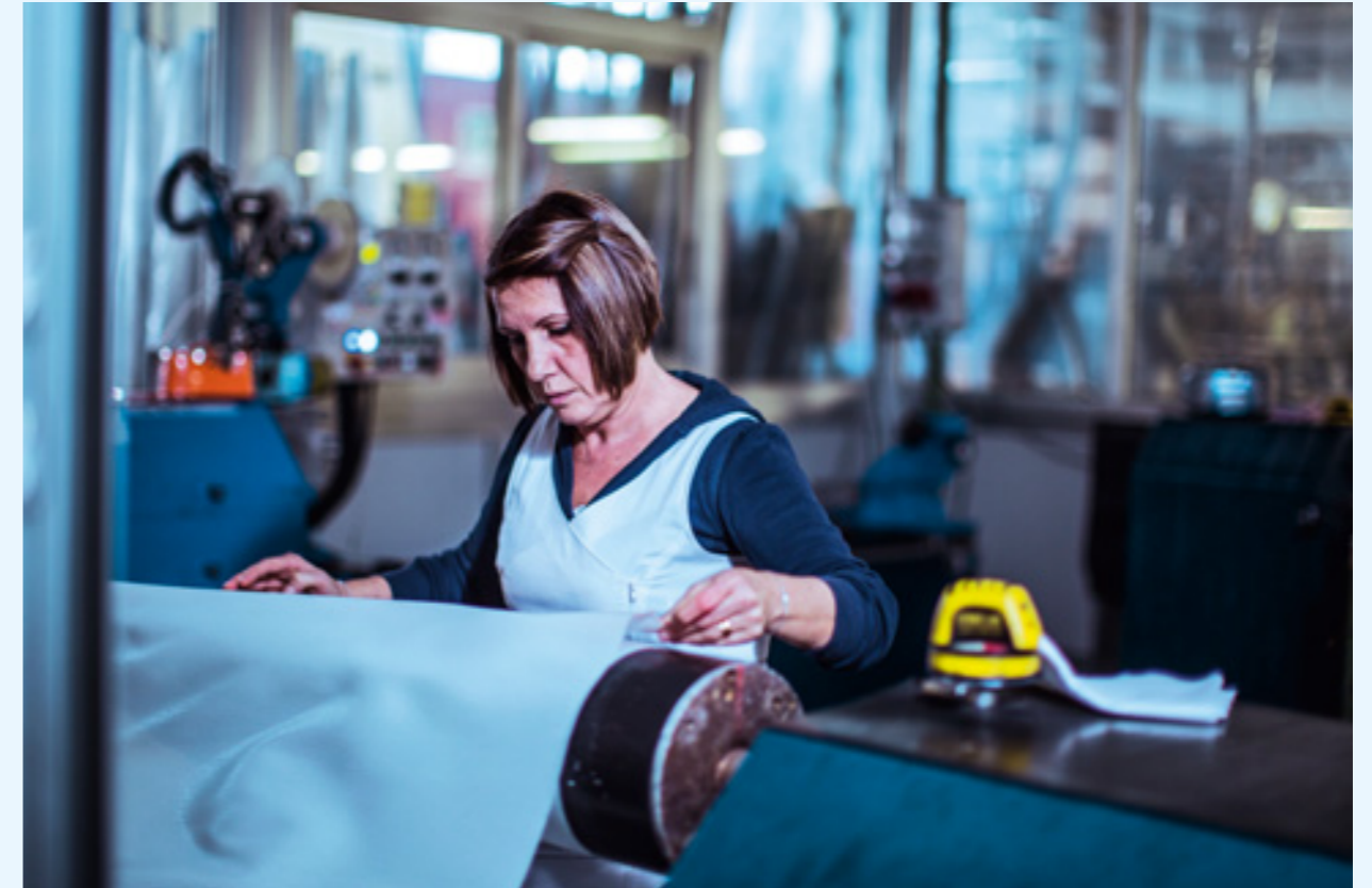
Il tessuto in fibra di vetro viene steso e avvolto a mano sullo stampo di Mite — The fibreglass fabric is stretched and hand-wrapped onto the mould for Mite — 拉伸玻璃纤维并用手将其缠绕在Mite的模上 — El tejido en fibra de vidrio se extiende y se utiliza para cubrir a mano el molde de Mite — Le tissu de verre est tendu et enroulé à la main sur le moule de Mite — ページ-Miteの鑄型の上に手作業で伸ばされ巻き付けられるグラスファイバー製の布地 — Das Glasfasergewebe wird ausgebreitet und von Hand auf die Form von Mite gewickelt — FAPS, 2017
