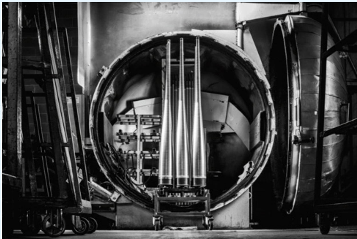
Mediante cottura in autoclave la lampada assume la sua struttura definitiva — The lamp is baked in an autoclave to give it its final structure — 在高压釜内烤制灯具, 形成其最终结构 — La lámpara asume su estructura definitiva mediante cocción en autoclave — La lampe acquiert sa structure définitive après cuisson en autoclave — ページ-オートクレーブ焼成により照明器具は最終的な構造を得る — Durch Erhitzen im Autoklav erhält die Leuchte ihre endgültige Form — FAPS , 2017
