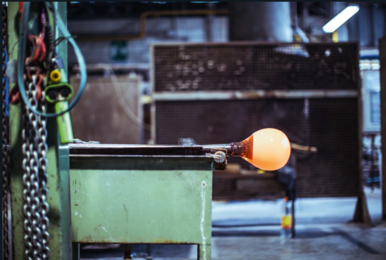
Canna da soffiatura con la pasta vitrea — Blowing cane with the vitreous paste — 帶有玻璃黏的吹制条 — Barra de soplado con la pasta vítrea — Canne de verrier avec la pâte de verre — ページ - 吹き竿と溶融されたガラス — Stab zum Glasblasen mit Glasmasse — Vetrofond, 2017
