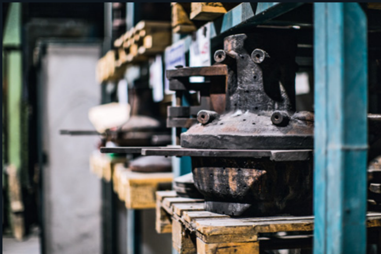
Stampi in ghisa per la soffiatura — Cast iron moulds for blowing — 吹制用的铸铁模 — Moldes en hierro fundido para el soplado — Moules en fonte pour le soufflage — ページ-吹きガラス製作用の鑄鉄の鑄型 — Zum Blasen verwendete Formen aus Gusseisen — Vetrofond , 2017
